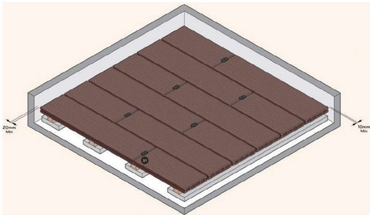
Obr. 7 – pokládka WPC desek s dodržáním dilatačních mezer
