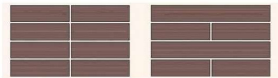
Obr. 8 – pokládka WPC desek
